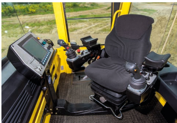
Дисплей для индикации и регулировки параметров машины.
