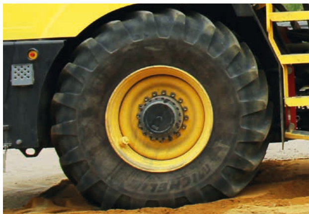
Колеса большого размера для меньшего давления на грунт.
