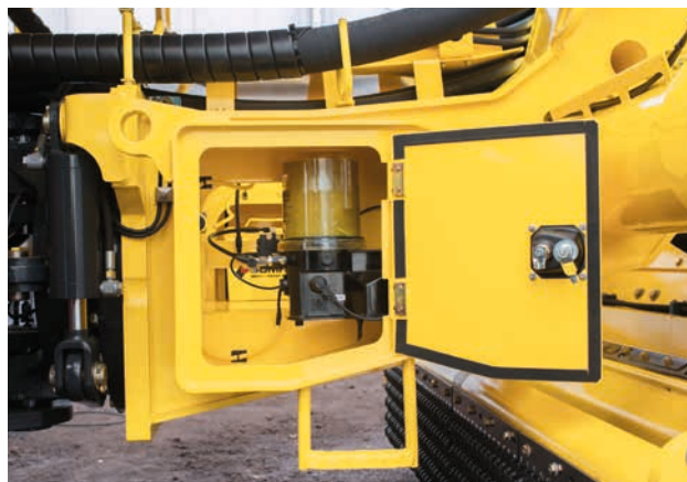
Серийно в RS 500: централизованная смазочная система.
