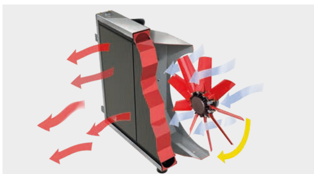
Реверсируемый вентилятор для более редкой очистки.
