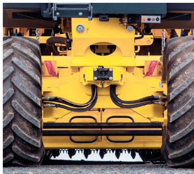
Задний мост с мощными независимыми приводами (RS 500).
