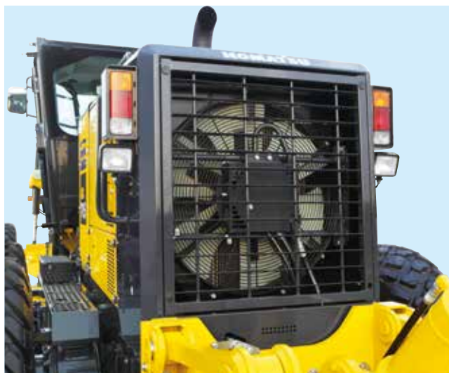
Работающий от гидропривода вентилятор радиатора
