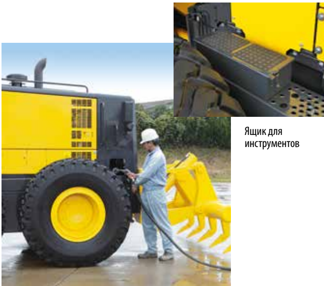
Дозаправка топливом доступна с уровня земли
