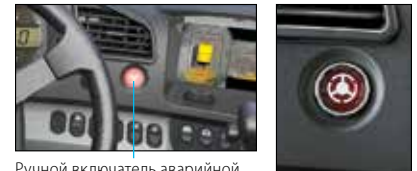
Ручной выключатель аварийной системы рулевого управления
